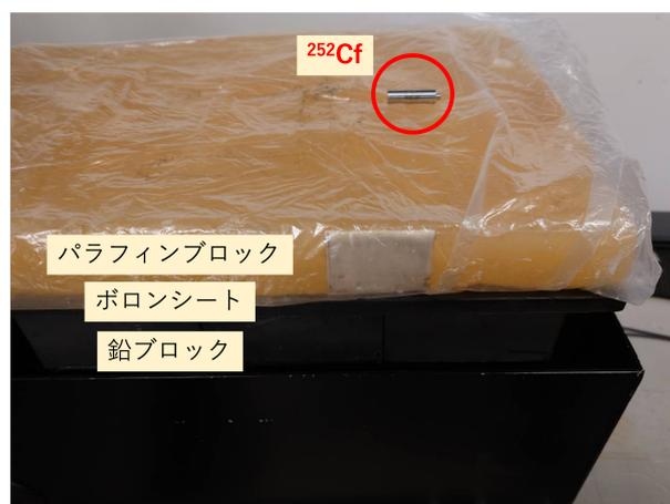
図 4.11  $^{252}\text{Cf}$  線源を用いたボロンシートの中性子遮蔽効果測定、(b) はボロンシート無しのエネルギースペクトルからボロンシート有りのエネルギースペクトルを差し引いたもの。
