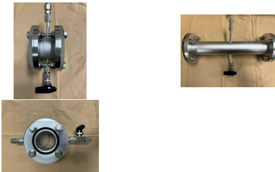
図 6.2 測定に使用したセル。左上:5 cm セル、右上:27.5 cm セル、左下: セルのアクリル面
