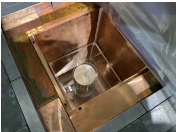
図 8：真ん中に見えるのがゲルマニウム検出器。測定試料を載せるためのアクリル台があり、周りから来る環境放射線を遮るための銅や鉛で出来たシールドで囲われています。
