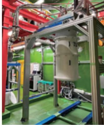
神岡地下実験室に設置した希釈冷凍機
