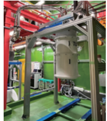
神岡地下実験室に設置した希釈冷凍機
