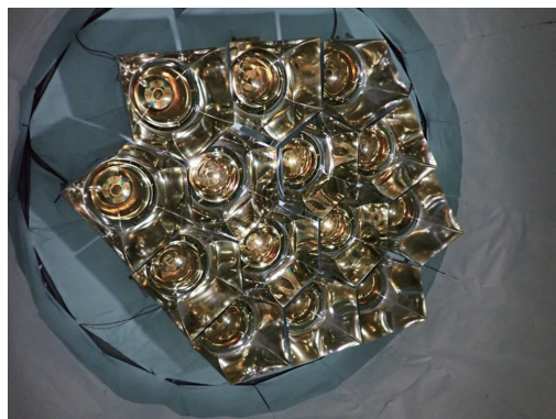
カムランド 2 プロトタイプ (集光ミラー付き高量子効率光センサー 14 個)
