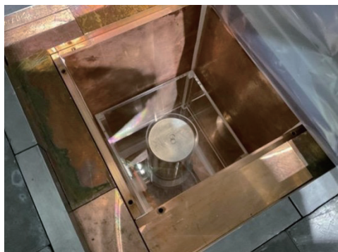
世界トップレベルの極低放射能 HPGe 検出器（中央）
